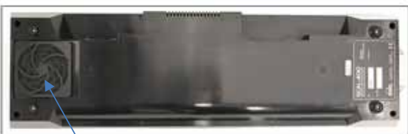
Cooling fan intake
